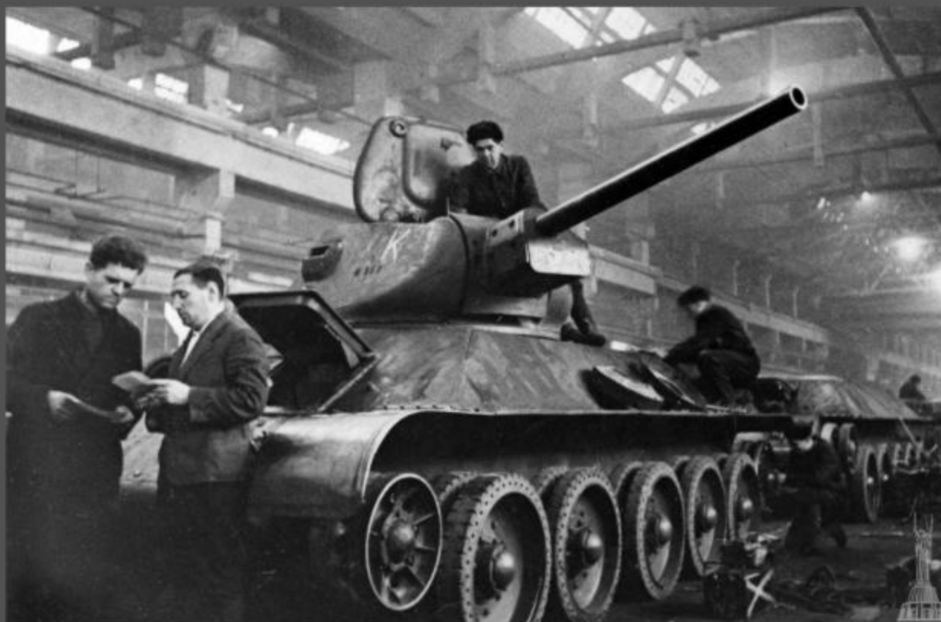
Конвеєрне складання танків Т-34 на одному з уральських заводів. 1943 р.
